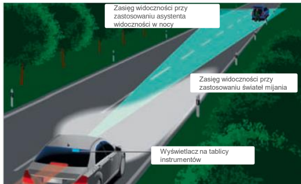
Porównanie zasięgu świateł mijania i zasięgu asystenta widoczności w nocy
