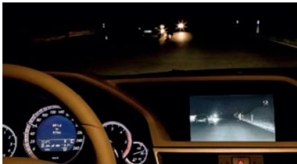
Informacja na centralnym wyświetlaczu o obrazie zarejestrowanym przez kamerę zbliżeniową na podczerwień
